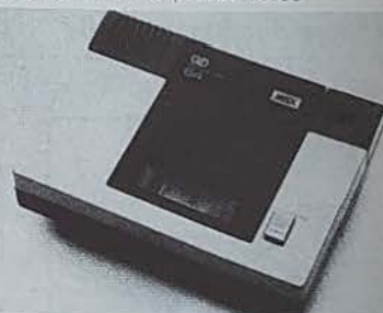
Date Recorder Philips D6450, capacité de stockage : 96 Kbytes à 2400 Bauds
