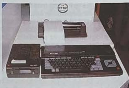
3 - Le Hit Bit HB 75 F accompagné du lecteur HBD 50 et de la table traçante PRN C41
