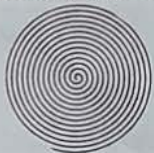
Disposition des sillons d'un disque musical
