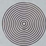
Disposition des sillons d'un disque musical
