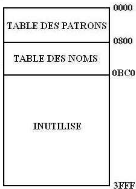
FIGURE 6-5 - PLAN DE LA VRAM EN MODE TEXTE
