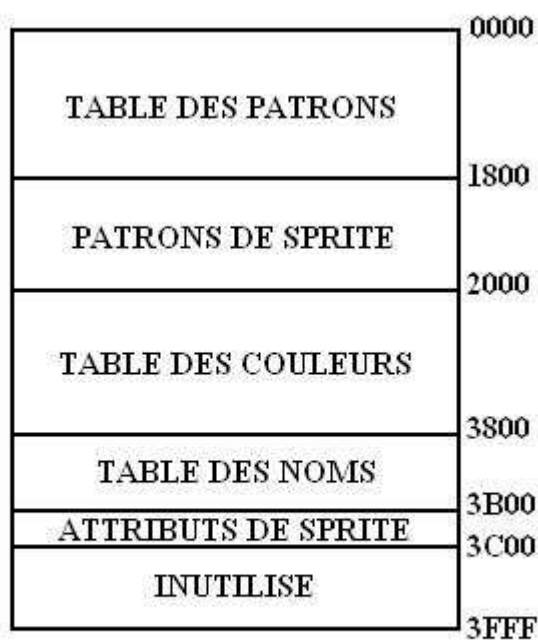
FIGURE 6-3 - PLAN DE LA VRAM EN MODE GRAPHIQUE 2
